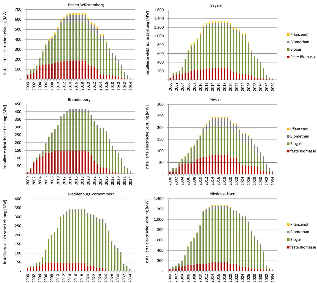
Abbildung 3-1: Voraussichtliche Entwicklung der installierten elektrischen Leistung des Anlagenbestandes bei Weiterführung des EEG 2014 und ohne Anschlussregelung für Bestandsanlagen auf Bundeslandebene für die Länder: Mecklenburg-Vorpommern, Niedersachsen
